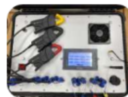
Мобильная лаборатория для обследования и диагностики электрических сетей 0,4-10 кВ на базе технологии синхронизированных измерений
