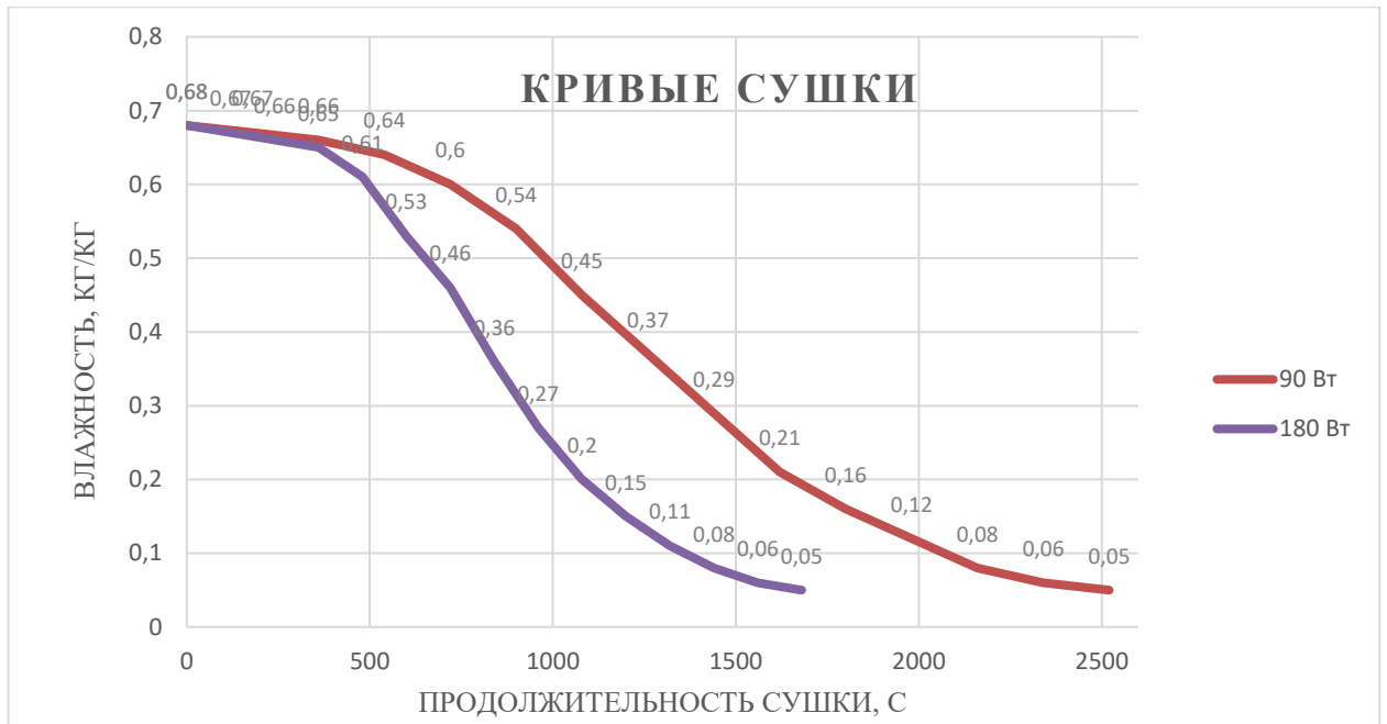
Рисунок 4.2 – Кривые МВ влагоудаления из ПСО при частоте 2,45 ГГц h = 1,5 см
