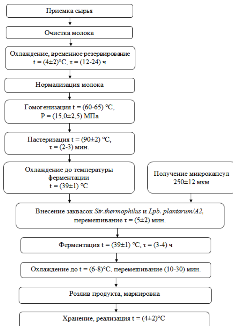
Рисунок 10 – Принципиальная схема производства кисломолочного продукта с использованием микроинкапсулированной культуры Lpb. plantarum
