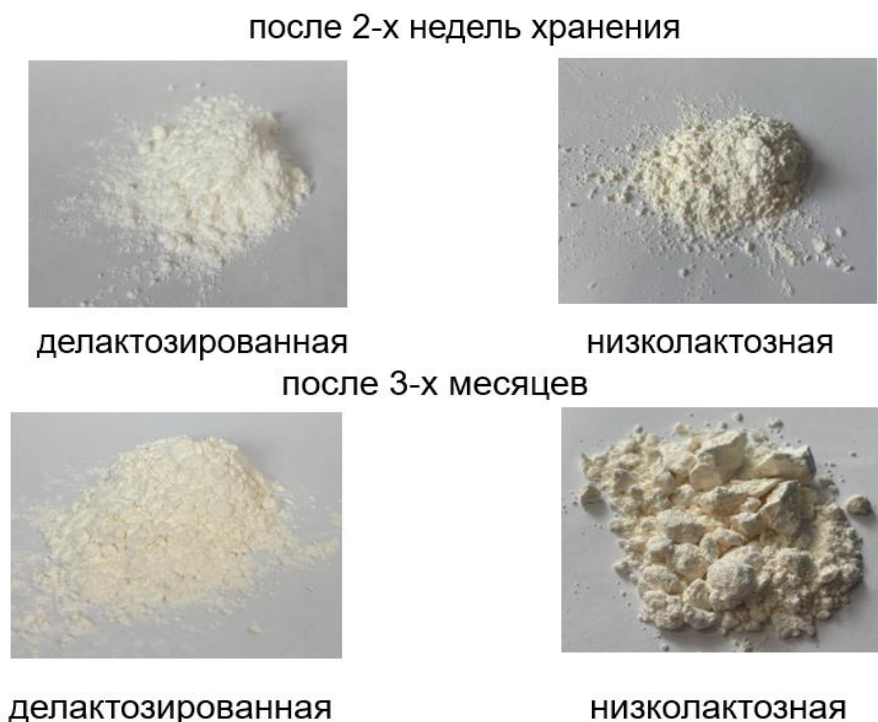
Рисунок 4.12 – Лабораторные образцы сухой делактозированной и низколактозной сыворотки после хранения в негерметичной таре
