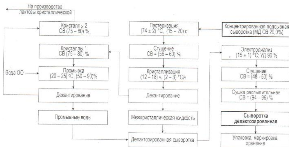
Рисунок 1 – Технологические этапы выработки делактозированной сыворотки.
