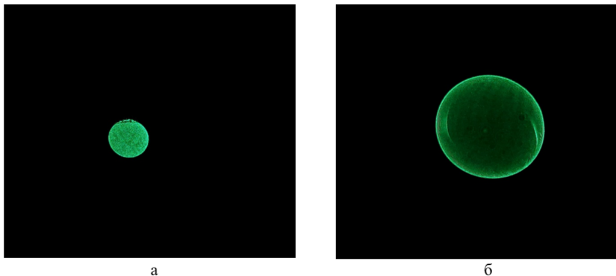
Рис. 2.12. Изменение картины термокапиллярного отклика при дополнительном воздействии однородного магнитного поля: а) H=2,5 кА/м, б) H=5 кА/м.
