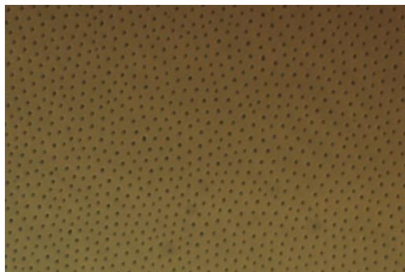
Рис. 3.6. Гексагональная структурная решетка при температуре 308 К, наблюдавшаяся при использовании образца №1.
