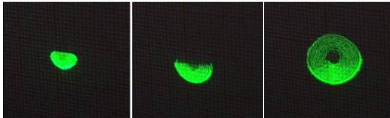
Рис. 2.39. Восстановление круговой симметрии светового пятна отклика с помощью воздействия вертикального неоднородного магнитного поля.
