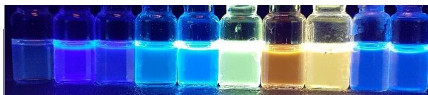
Рисунок 12 – Флуоресценция растворов в ДМСО при облучении УФ-светом (365 нм), слева направо: DMP , 3a , 3d , 3e , 3f , 3h , 3i , 3j , 5a , 5c
